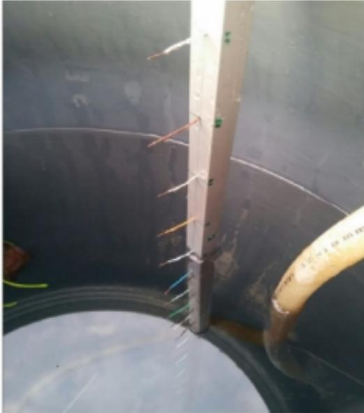
Los sensores físicos son simplemente cables, el conjunto de sensores se realiza de forma casera, con varios cables sujetos a un pie vertical, y apoyado o sujeto en el interior del depósito.
